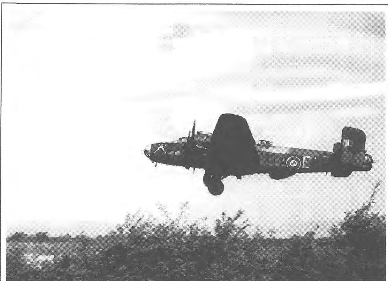
Au décollage. Remarquez les tourelles de mitrailleuse (au-dessus et à l'arrière) et le radar HS (sous le fuselage).
